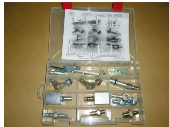
DODATKOWE ZESTAWY ADAPTERÓW UMOŻLIWIĄJĄCE W SUMIE SERWISOWANIE WSZYSTKICH OBECNIE UŻYTKOWANYCH AUTOMATYCZNYCH SKRZYŃ BIEGÓW
