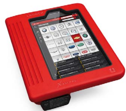
PROFESJONALNY TESTER DIAGNOSTYCZNY X-431 PRO FIRMY LAUNCH – ODPOWIEDNI DO DIAGNOZOWANIA ELEKTRONICZNYCH STEROWNIKÓW AUTOMATYCZNYCH SKRZYŃ BIEGÓW
