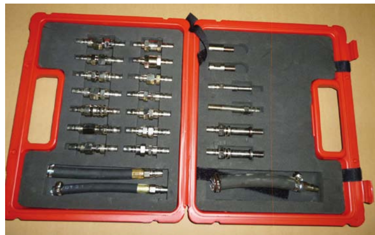
ZESTAW ADAPTERÓW STANOWIĄCY STANDARDOWE WYPOSAŻENIE URZĄDZENIA SERWISOWEGO
